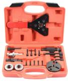
**EXTRACTOR DE CLUTCH PARA COMPRESOR DE AIRE ACONDICIONADO**
